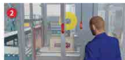
2. Obsluha stroje otevře jistič ochranný kryt a opraví pásku. Operace zařízení je zaprotokolována v systému.
