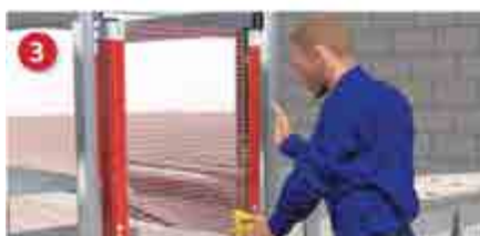
3. Obsluha stroje vyčistí světelnou závoru a předejde tak zbytečné odstávce stroje.
